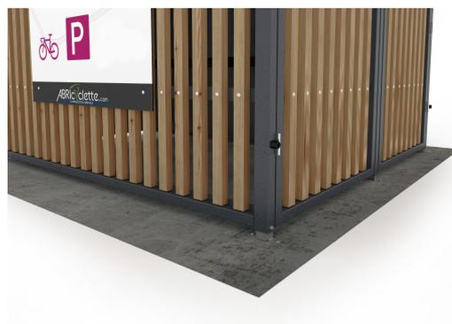
Platines à splitter au sol par scellements chimiques ou vis béton. La platine pivote pour se régler en hauteur et permettre le réglage du niveau selon les irrégularités du sol.
