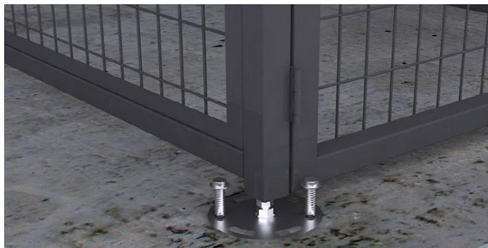
Platines à splitter au sol par scellements chimiques ou vis béton. La platine pivote pour se régler en hauteur et permettre le réglage du niveau selon les irrégularités du sol.
